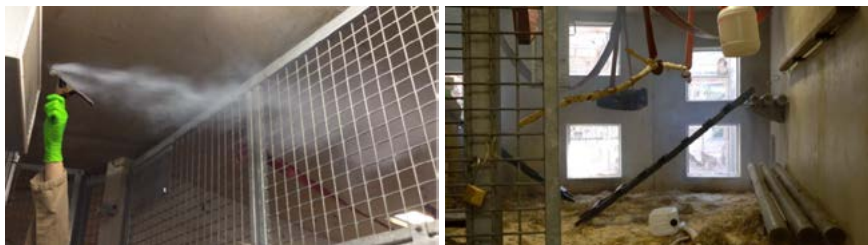
Fig. 4 Links een foto van het aansteken van een rookpatroon vlak voor de luchtinlaat in het resus gebouw. De rook wordt door het gaasraam in het verblijf geblazen. Rechts een foto van het verblijf 6 minuten na het inblazen van de rook. De rook is grotendeels weer afgezogen.
